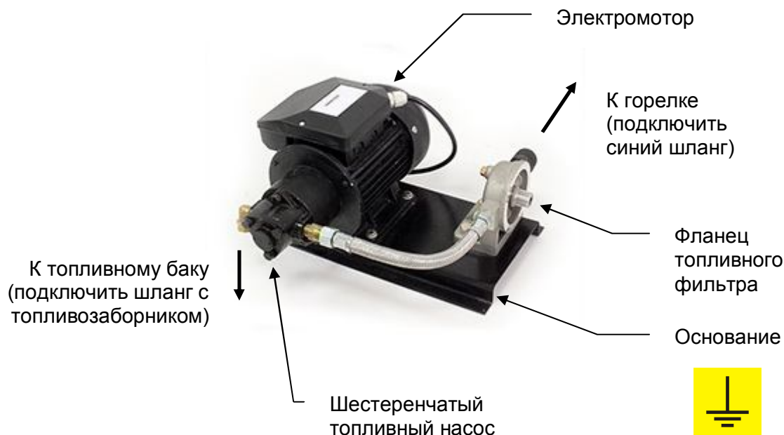
Рис. 12. Подъемный агрегат с фильтром тонкой очистки
